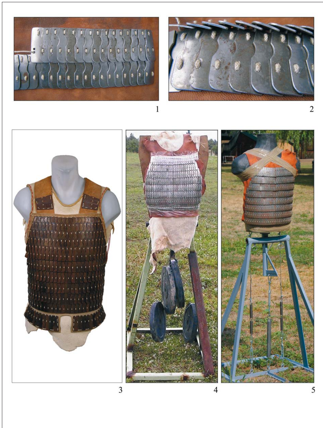
3. kép. 1–2: A teszpáncél fűzsmódja; 3: A Kunszentmártoni Helytörténeti Múzeumban látható páncél; 4: Súlyvezérelt bábu; 5: Rugóvezérelt bábu
